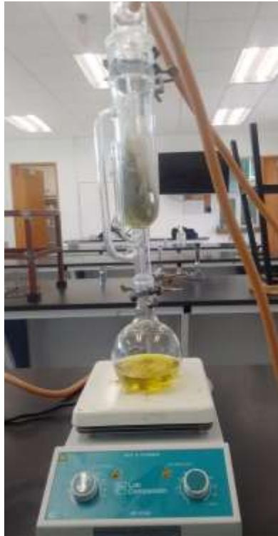
**Figura 23.** Lavados de la maleza en el equipo soxhlet.
