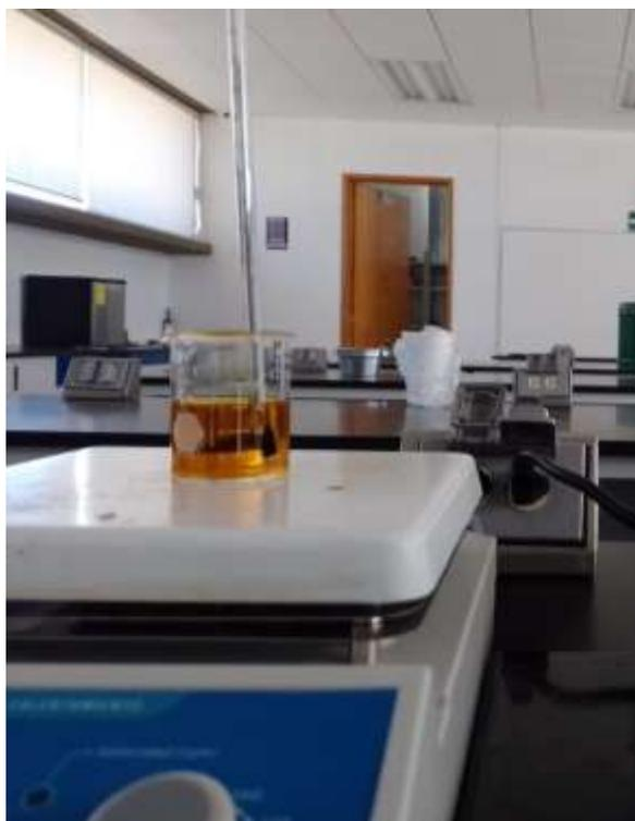
**Figura 27.** *Agitación de aceite vegetal a 100 rpm x 6hrs.*
