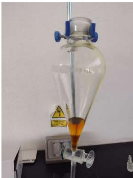
**Figura 32.** Separación de biodiésel en embudo de decantación (Corrida #3).
