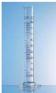
**Figura 48.** Probeta graduada.
