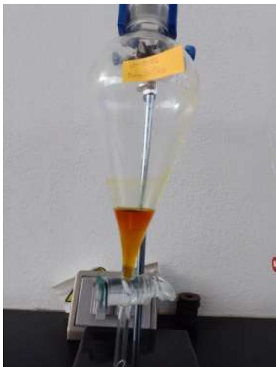
**Figura 31.** Separación de biodiésel en embudo de decantación (Corrida #2).
