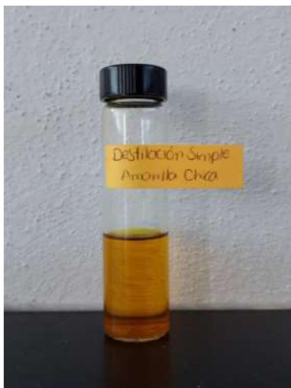
**Figura 26.** Resultado de la destilación simple (18 ml, aceite vegetal).
