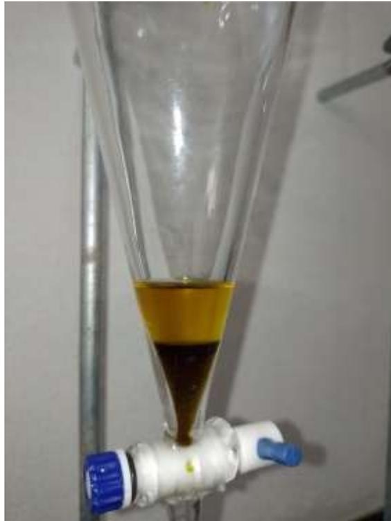
**Figura 33.** Separación de biodiésel en embudo de decantación (Corrida #4).
