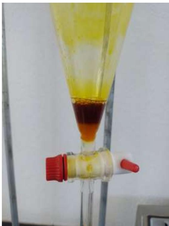
**Figura 30.** *Separación de biodiésel en embudo de decantación (Corrida #1).*
